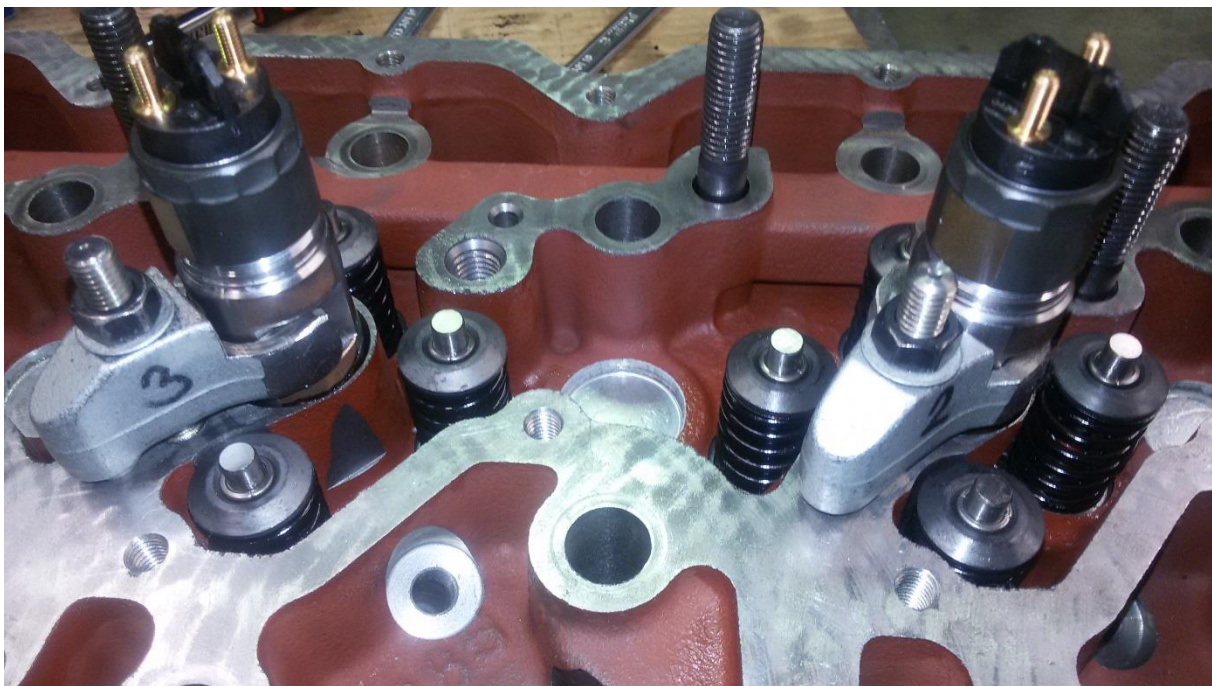
Obrázek 4 Prototyp motoru P3 – uchycení vstříkovačů v hlavě válců
