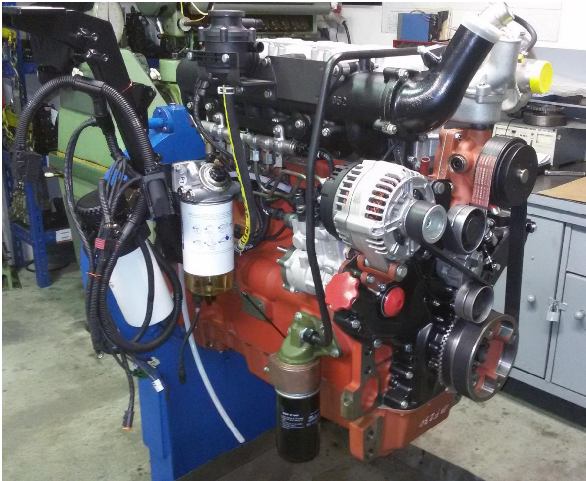
Obrázek 1 Prototyp motoru P3 s akumulacním vstřikovacím systémem
